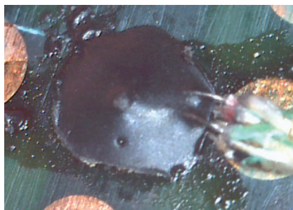
図 3-14 熱電対の取付け （接着剤による方法）
