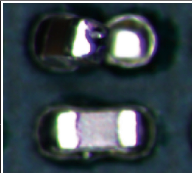
図 8-8 リフローの欠陥 – トウムストーン現象
