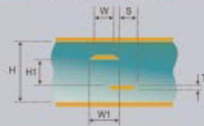
Offset Coplanar Waveguide
